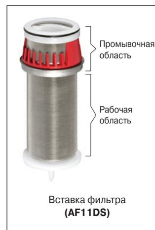
При перекрытии расположенного внизу колбы шарового крана, давление внутри колбы стабилизируется, и вставка под воздействием пружины возвращается снова вверх, в рабочее положение.
