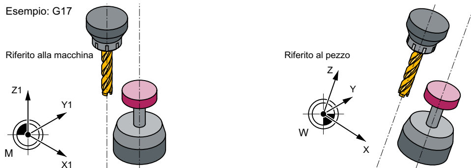
Figura 4-36 Orientamento parallelo dell'asse dell'utensile, dell'asse del tastatore di misura e dell'asse del sistema di coordinate
