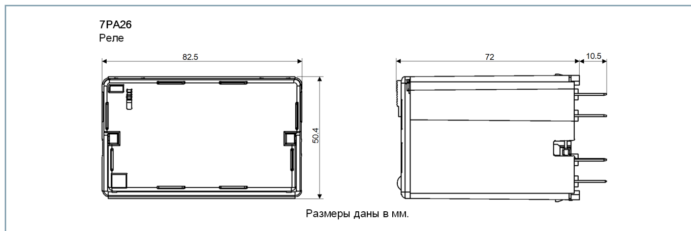
Рисунок 2.5/3 Габаритные и установочные размеры
