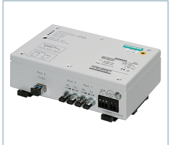
Рисунок 3.7/7 Оптический повторитель с источником питания широкого диапазона
