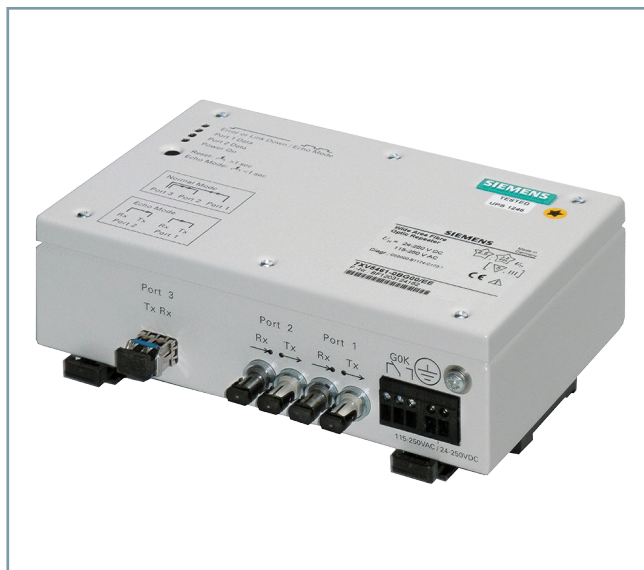
Рисунок 3.7/1 Оптический повторитель со встроенным мультиплексором с длиной волны 1300 нм/1550 нм для 1 одномодового оптоволоконного кабеля
