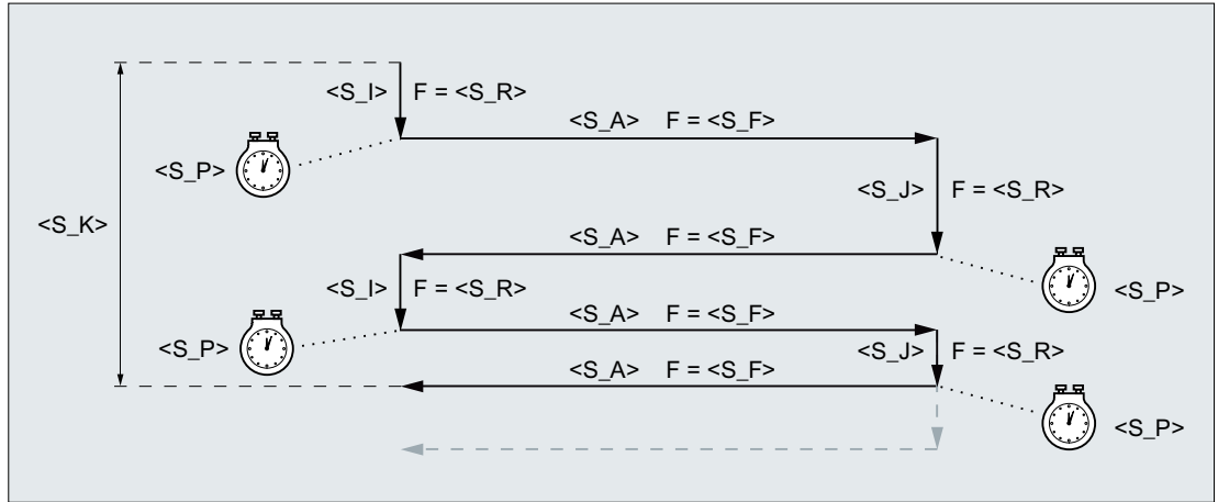
Resim 9-9 İkinci dönüş noktasının ayarlanmasıyla toplam ayarlama derinliğine ulaşılır
