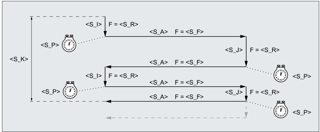
Resim 9-5 İkinci dönüş noktasının ayarlanmasıyla toplam ayarlama derinliğine ulaşılır
