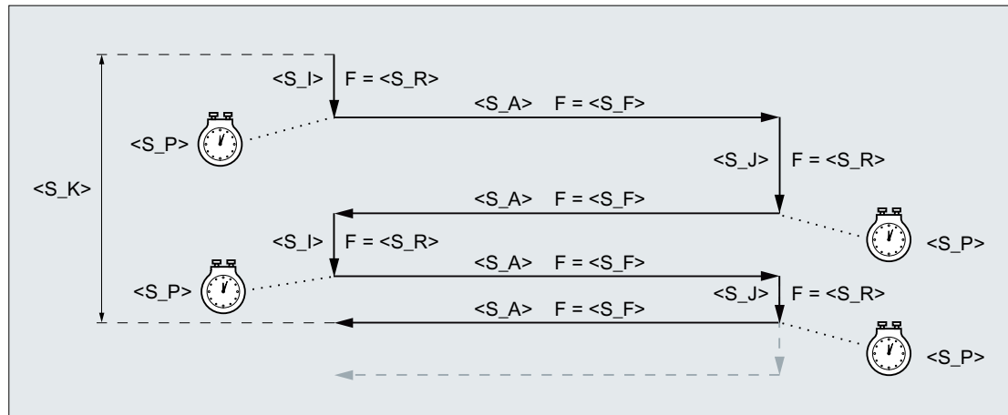
Figure 9-9 Profondeur de passe totale atteinte lors de la pénétration au deuxième point d'inversion
