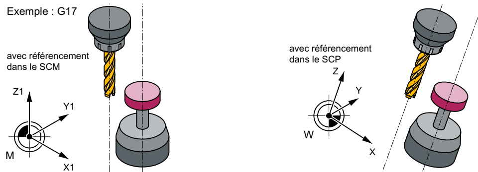
Figure 4-36 Orientation parallèle de l'axe d'outil, de l'axe du palpeur et de l'axe du système de coordonnées
