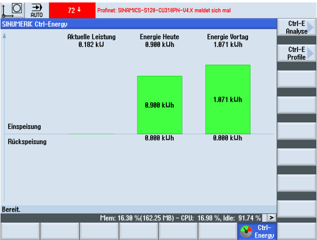
Figure 16-1 Ecran d'entrée Ctrl-Energy avec affichage de la consommation d'énergie instantanée
