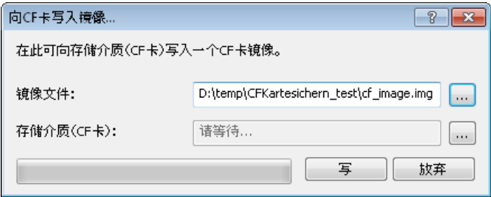
图 6-56 写入 CF 卡镜像
