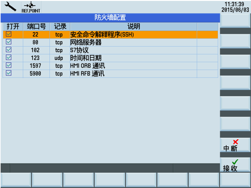
图 5-2 808D 防火墙设置
