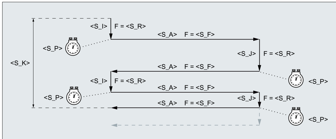
圖像 9-5 以第二反轉點的進給達到總進給深度
