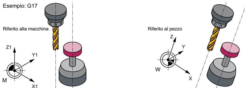
Figura 3-35 Orientamento parallelo dell'asse dell'utensile, dell'asse del tastatore di misura e dell'asse del sistema di coordinate
