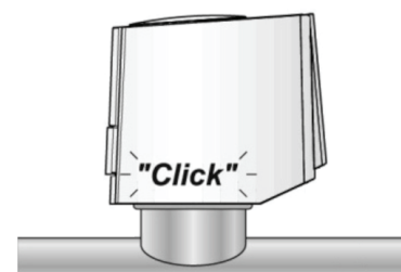
Rys. 10 Krok 3: Wcisnąć siłownik na adapter
