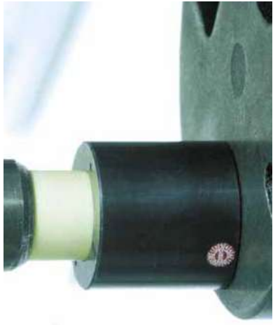
Obraz 12: Łożysko powinno być wciśnięte w gniazdo za pomocą prasy
