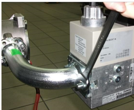
8) установить электроклапан и Прикрепить из фланец;
