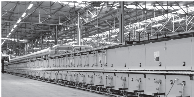
Керамическая промышленность: печь с роликовым подом
