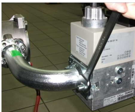
8) установить электроклапан и Прикрепить из фланец;
