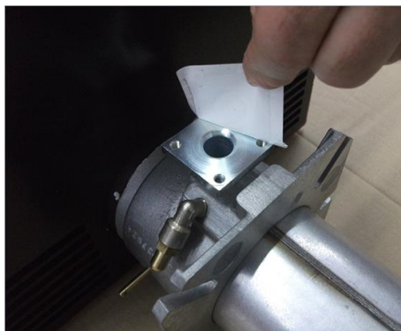
2) повернуть Горелка и Снять заглушку;
