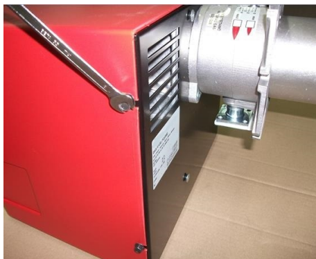
1) Снять кожух, ослабив 4 винта;
