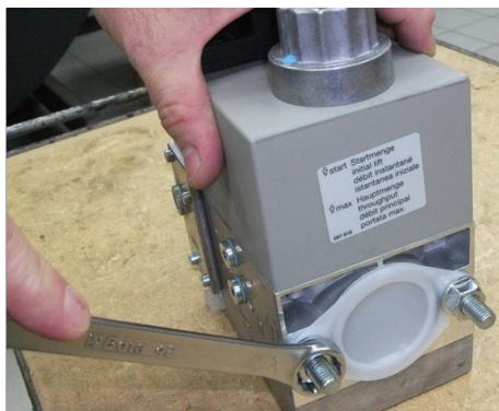
8) Снять заглушку из электроклапан;
