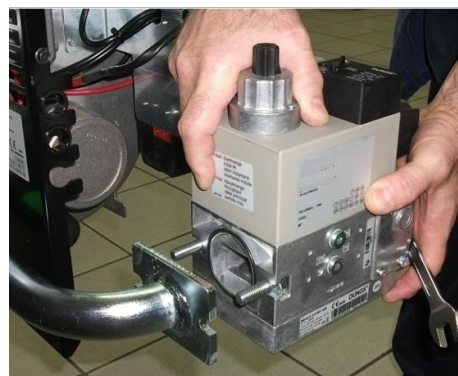
9) установить электроклапан на Труба ГАЗОВОЙ ramпы;
