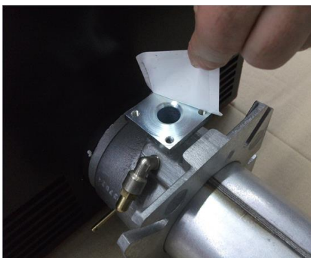
2) повернуть Горелка и Снять заглушку;
