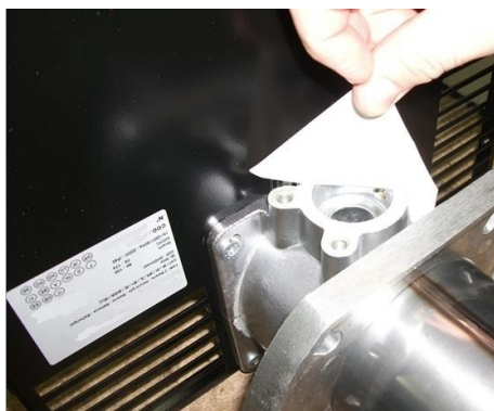
2) повернуть Горелка и Снять заглушку;
