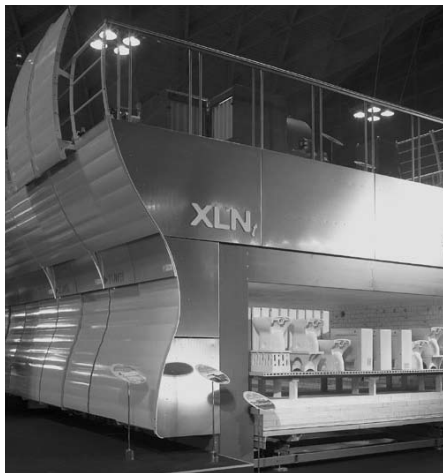
Печь с выкатным подом в керамической промышленности
