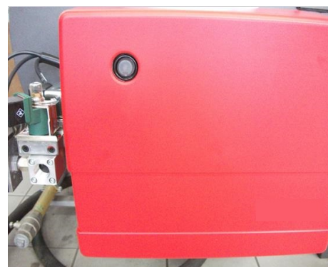
9) Переустановите кожух и Подключить газовую арматуру к газопроводу.
