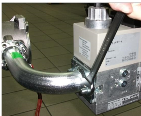
8) установить электроклапан и Прикрепить из фланец;
