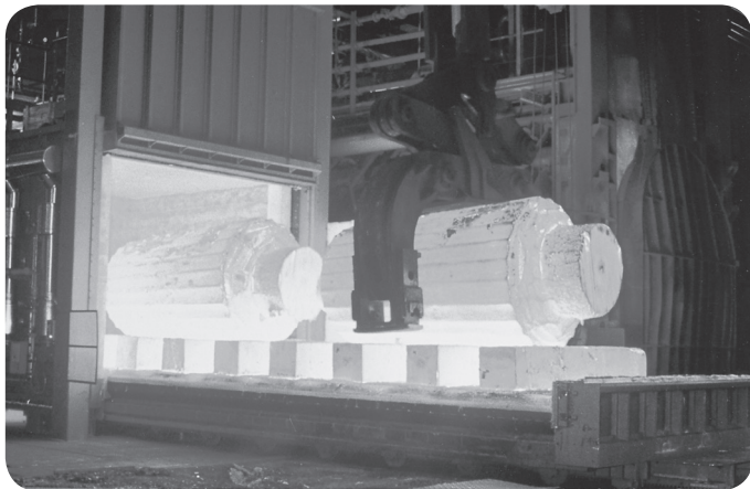
Металлургическая промышленность: кузнечная печь
